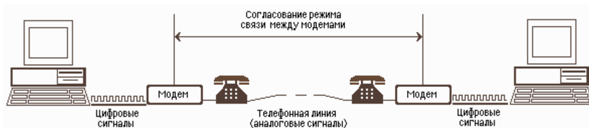
Рис. 7. Схема реализации модемной связи
